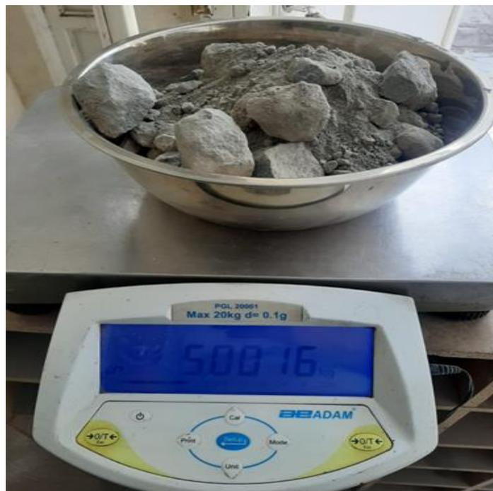
*Nota.* Se observa el registro del peso del agregado grueso
