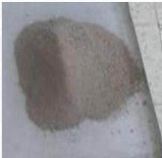
*Nota.* Se observa el agregado fino tamizado listo para el ensayo de Proctor
