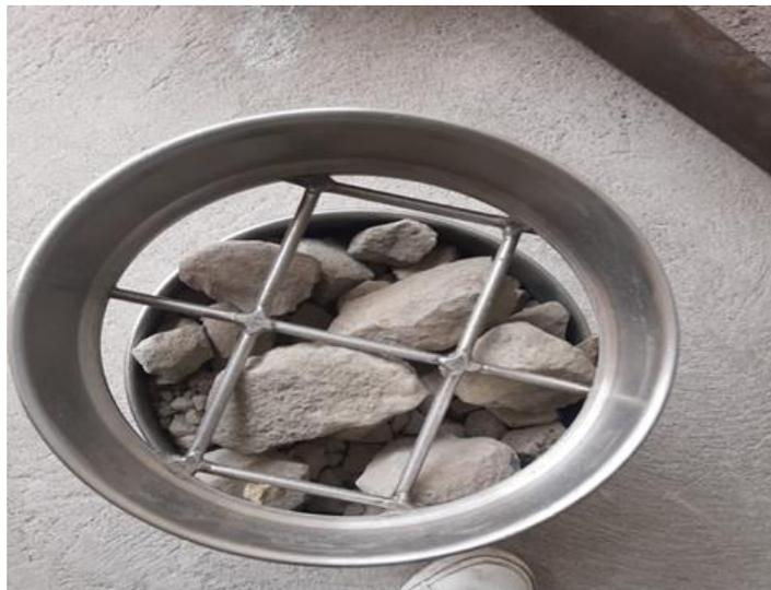
*Nota.* Se observa el agregado grueso tamizado listo para el ensayo de proctor
