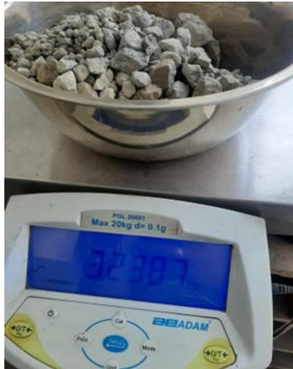
*Nota.* Se observa el registro del peso de la segunda muestra del agregado grueso
