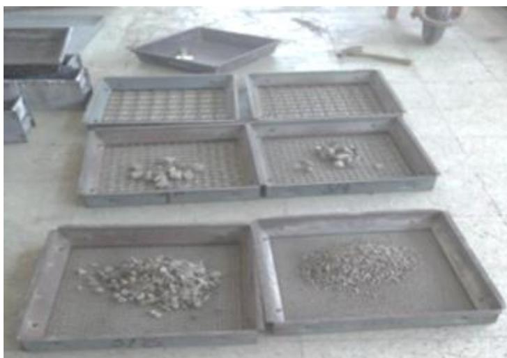
*Nota.* Se observa los agregados finos y gruesos a utilizar en los ensayos
