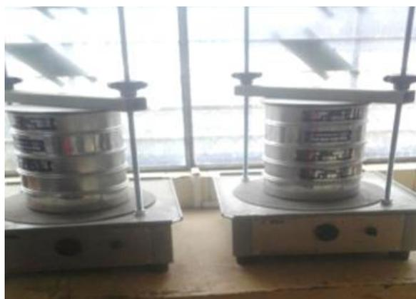
*Nota.* Se observa el ensayo de granulometría a través del tamizado
